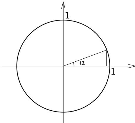
Вспомним определение синуса угла. Если мы будем рассматривать некоторый малый угол (см. рисунок), то очевидно, что длина противолежащего катета практически совпадает с длиной дуги, стягиваемой углом, а она для единичной окружности по определению равна величине угла в радианах. Таким образом, получаем важный вывод — если угол  $\alpha$  мал, то, если он выражен в радианах, верно утверждение  $\sin \alpha \approx \alpha$ .
